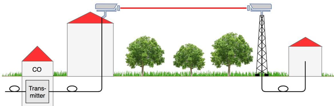
Figure 35 – Réseau FSO permettant d'atteindre les zones isolées
