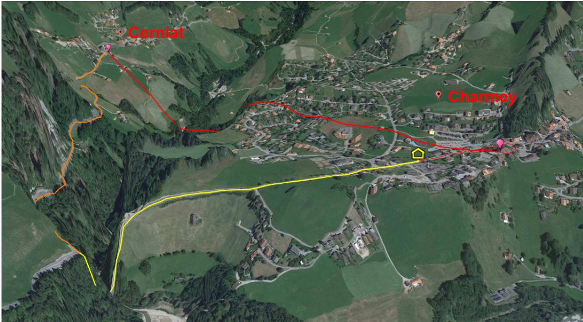
Figure 136 – Liaison FSO (Free Space Optic) entre Charmey et Cerniat avec analyse du relief
